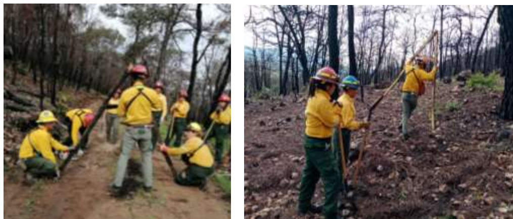
Fig. 13.- Capacitación para la fabricación y uso de nivel “A” para establecer curvas de nivel en los trabajos de conservación de suelos.
